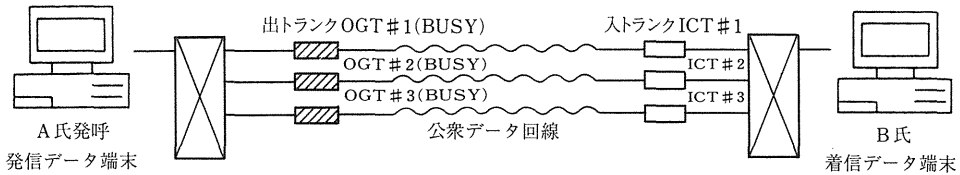
出トランクOGT # 1 ~ # 3 がすべて使用中 (BUSY) 状態で、A氏が発呼した場合
