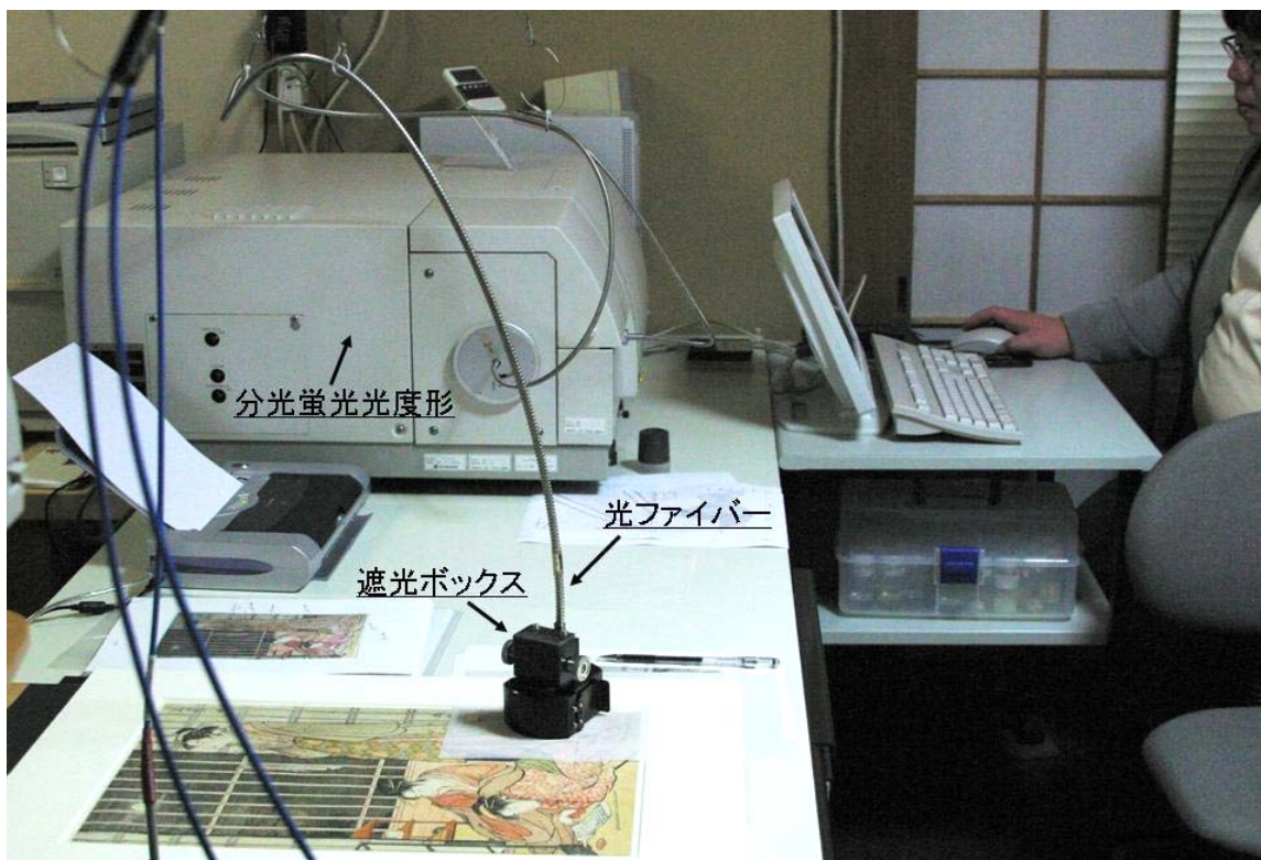
Fig. 4 三次元蛍光スペクトル分析装置による浮世絵版画に使用された「染料」の分析
