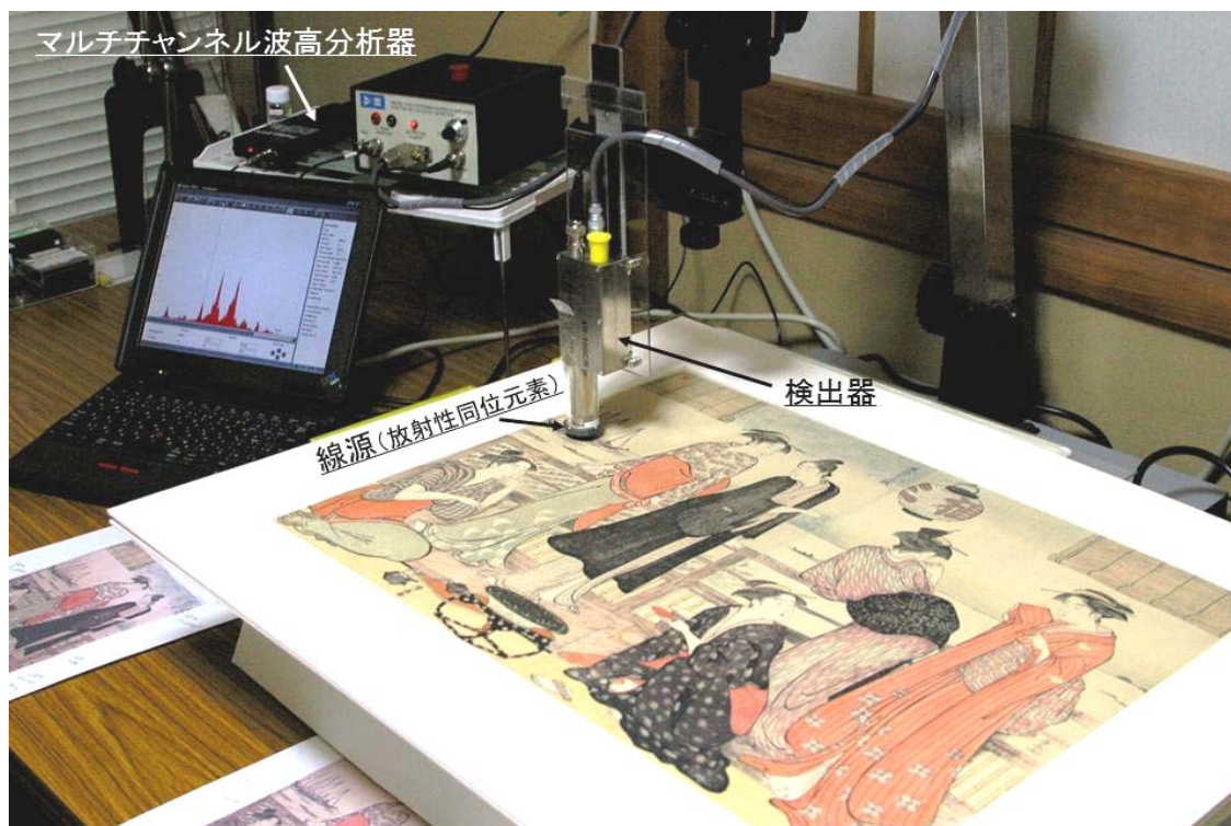
Fig.2 簡易携帯型蛍光X線分析装置による浮世絵版画に使用された「顔料」の分析
